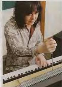
自らセットアップを行なう難波弘之。各鍵ごとに装備されたトーン・バーの位置で音色、ピックアップとの距離で音量をコントロールできるので、プレイヤーの好みに合わせてサウンドメイクが可能だ。
